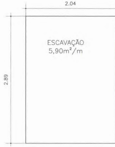
● VOLUME DE ESCAVAÇÃO BSC Ø1,00m ESCALA: 1/25
